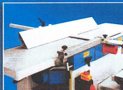
Наклон на линеала от 90° до 45° Abrichtanschlag von 90° auf 45° schwenkbar Fence tilting from 90° to 45°
